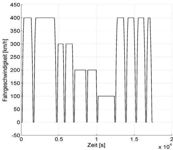
Abbildung 8. Fahrprofil NGT
